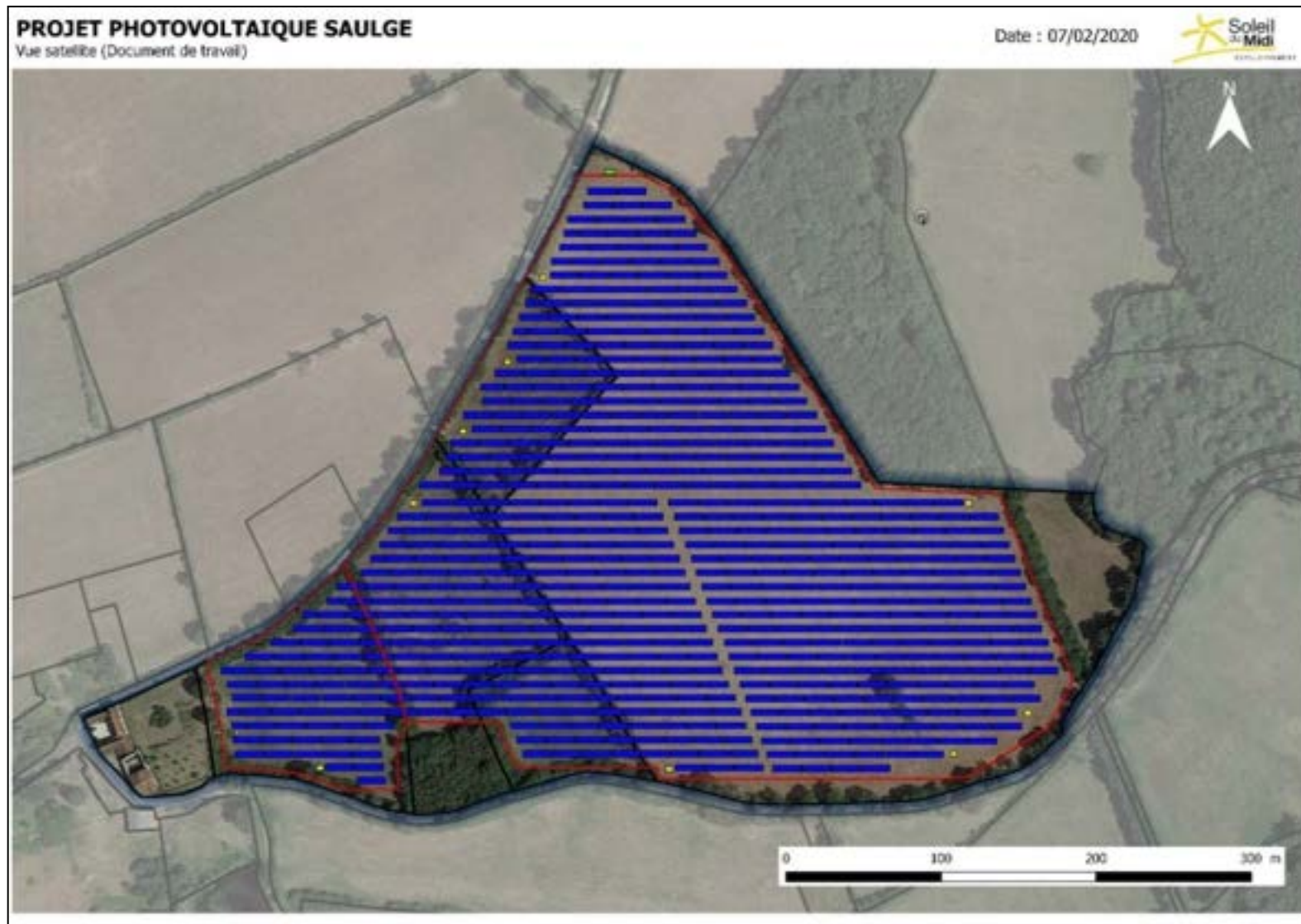
Figure 185: Présentation de la variante 1 du projet de centrale photovoltaïque au sol de Saulgé (Source : Soleil Du Midi Développement)
