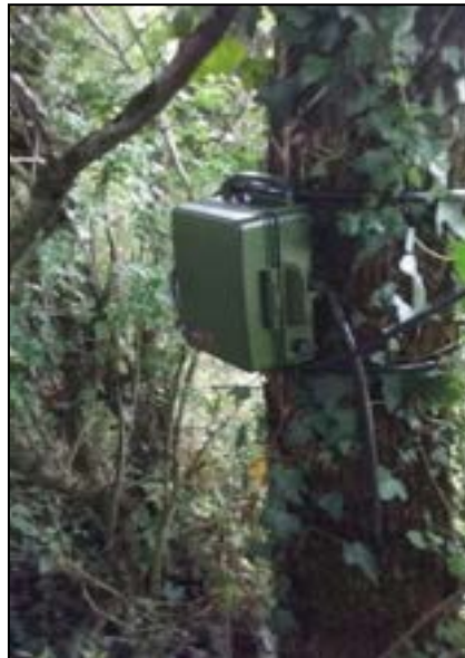
Figure 204 : Installation d'enregistreur continu SM4BAT © NCA Environnement
